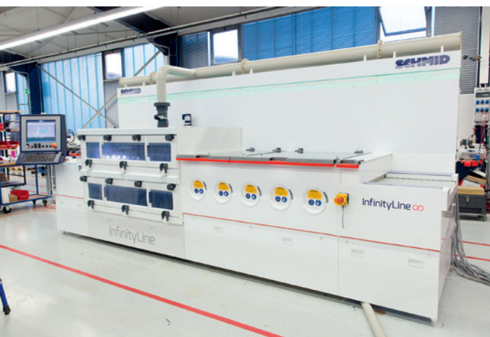
Nassprozessanlage mit Ätzmodul der Schmid Group: Die Entwicklung der neuen Modullinie InfinityLine basiert auf den Vorgängertypen CombiLine und PremiumLine
